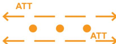
Las estructuras de ductos marcadas con un ancho superior a 36 pulgadas en total, requerirán que la instalación subterránea notifique al excavador e identifique el tamaño del marcado. Cualquier estructura de ductos marcada en exceso de su tamaño real se considerará sobre-marcada y se interpretará como una posible infracción de los estándares de marcado.
