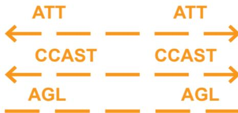
Las estructuras de **ductos** son múltiples conductos apilados o colocados uno al lado del otro, instalados al mismo tiempo en una sola zanja o camino de perforación, que pueden o no estar recubiertos con una estructura protectora. Estas instalaciones deberán marcarse utilizando un punto con una demarcación paralela a cada lado del punto.
