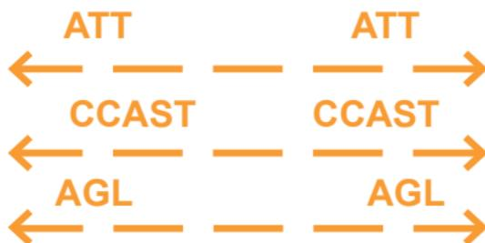
Las estructuras de **ductos** son múltiples conductos apilados o colocados uno al lado del otro, instalados al mismo tiempo en una sola zanja o camino de perforación, que pueden o no estar recubiertos con una estructura protectora. Estas instalaciones deberán marcarse utilizando un punto con una demarcación paralela a cada lado del punto.
