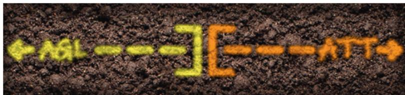
Las líneas que tengan conexiones (por ejemplo, en forma de T o Y) o cambios de dirección deberán ser claramente indicadas. Las marcas que indican líneas o conexiones deberán mostrar claramente la intersección y el trayecto de la línea o conexión. Las marcas que muestren cambios de dirección deberán colocarse más cerca unas de otras para mayor claridad y precisión.
